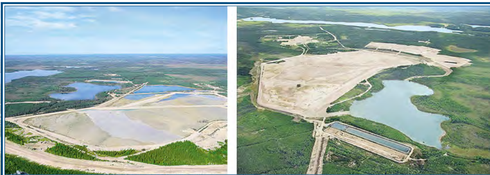
Рис. 4.23. Вид на хвостохранилище Клафф Лейк в период ведения горных работ (слева) и после проведения работ по выводу из эксплуатации (справа)
